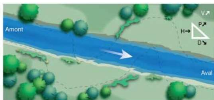
Cours d'eau rectifié : lit mineur canalisé. Distance raccourcie, pente accentuée ; accélération de la vitesse. Écoulements et milieux aquatiques appauvris et homogènes.
